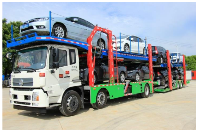
图 9：合规轿运车（中置轴车，运载 8 辆）
